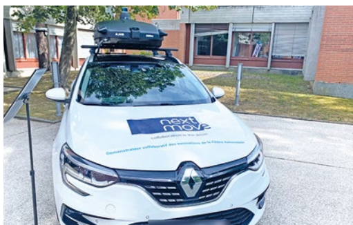
L'ARGObox, un concentré de technologie permettant de transformer un véhicule lambda en un véhicule autonome.
